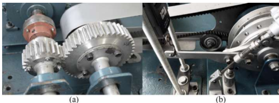
Figura 3 Montaje experimental: (a) engranaje y (b) brazo de palanca. Fuente: Autoría propia.
