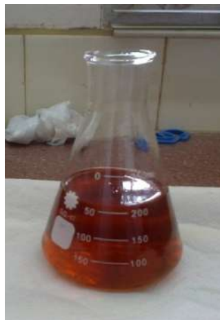
Figura 4 Biodiesel a partir de AVUs-Método Esterificación ácida-básica Planta Piloto II-Facultad de Ingeniería-UNSa Fuente: Elaboración propia
