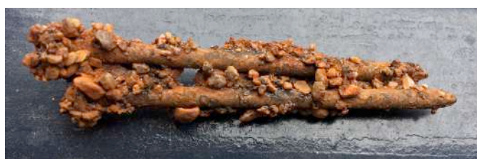
Figura 5 Complejo adsorbente formado entre la arena y los clavos, responsable de la eliminación efectiva del arsénico del agua surgente de la zona de San José de Boquerón.
