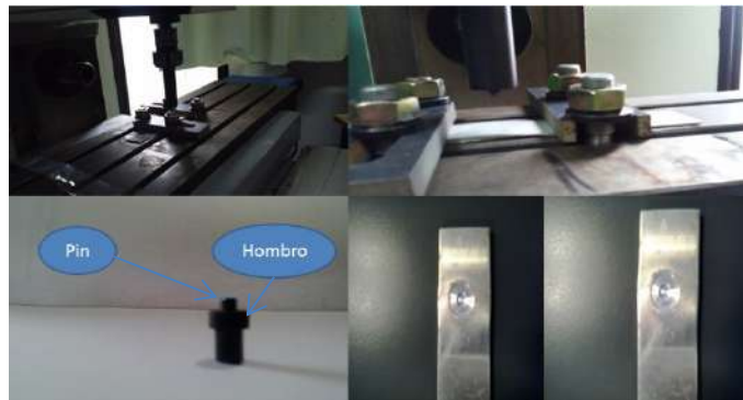
Figura 6. Proceso de soldadura en dos placas de Aluminio
