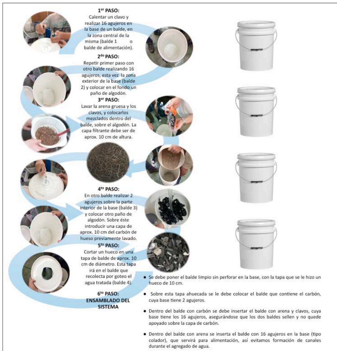
Figura 3 Pasos a seguir para el armado del filtro para la eliminación de arsénico y fluoruros del agua para consumo humano.
