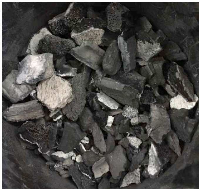
Figura 4 Carbón adsorbente obtenido a partir de huesos de vaca calcinados a fuego directo.
