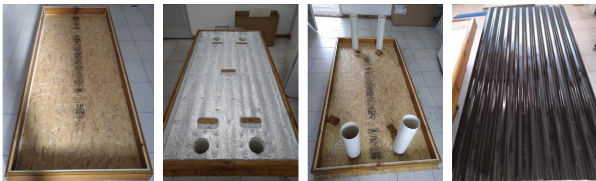
Figura 9: Proceso de fabricación del panel solar de aire caliente
