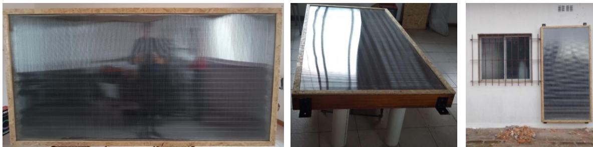
Figura 10: Panel de aire caliente terminado e instalado en el laboratorio de la SECyT FRTL UTN
