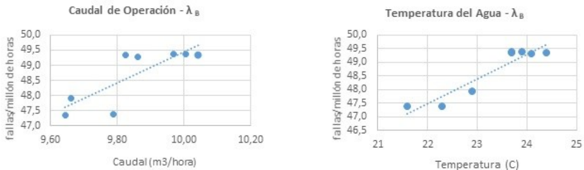
Figura N° 8. Incidencia de la temperatura y el caudal en la determinación de la tasa instantánea de fallas.
