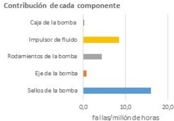
Figura N° 9. Contribución de componente a la estimación de la tasa instantánea del sistema.
