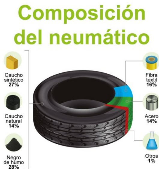
Figura 1: Composición del neumático
