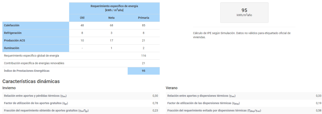
Figura 22. Prestaciones energéticas Modelo Mampostería c/aislación.
