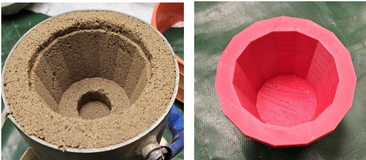
Figura 6 y 7: Molde de impresora 3D y elaboración de la matriz
