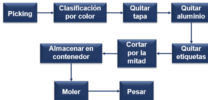
Figura 4 - Secuencia de operaciones del proceso de molido
